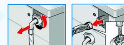
7. В зависимости от модели, отсоедините шланг от задней стенки машины и проведите чистку фильтра.
