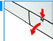
2. Осторожно откручивайте крышку насоса до тех пор, пока не попьется раствор моющего средства. Когда крышка отверстия для проведения сервисного обслуживания наполнится наполовину, закрутите крышку насоса и вылейте воду. Повторяйте процесс до тех пор, пока весь раствор моющего средства не выпечет.
